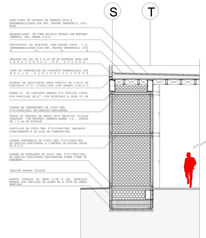
CORTE POR FACHADA ENTRE EJE 17 Y 18 ALBAÑILERÍA MUROS - FACHADA
