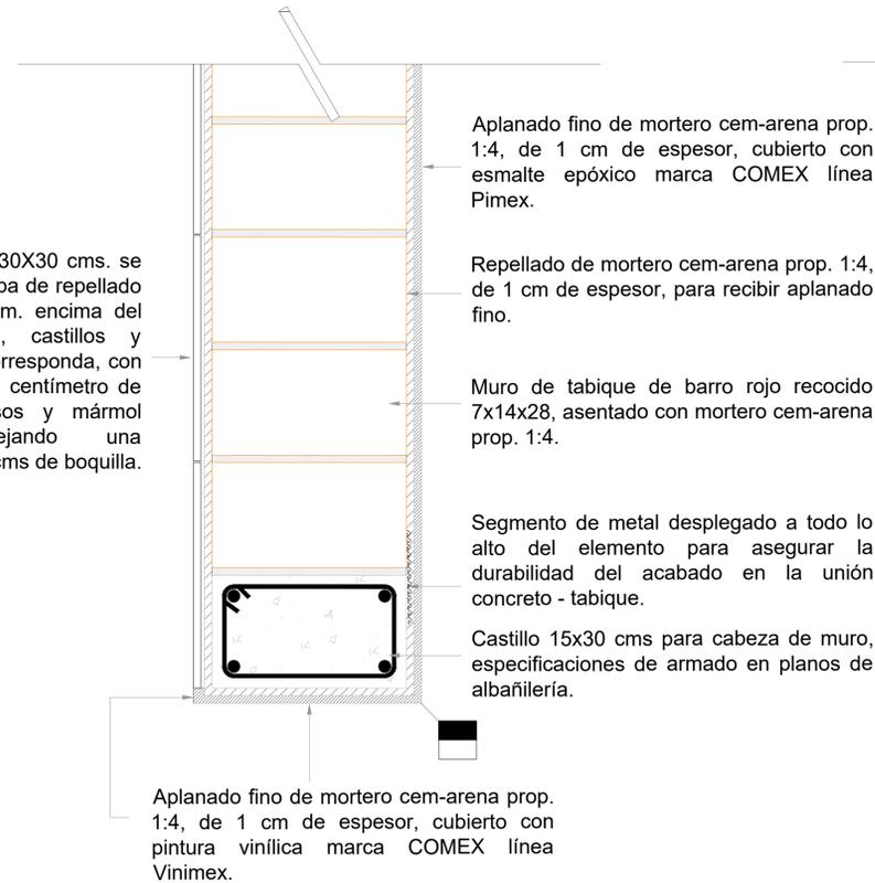
Aplanado fino de mortero cem-arena prop. 1:4, de 1 cm de espesor, cubierto con esmalte epóxico marca COMEX línea Pimex.
