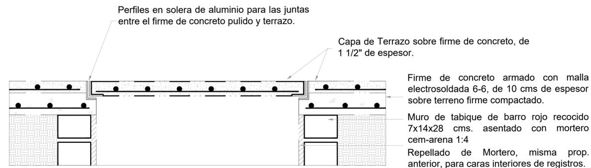
Perfiles en solera de aluminio para las juntas entre el firme de concreto pulido y terrazo.
