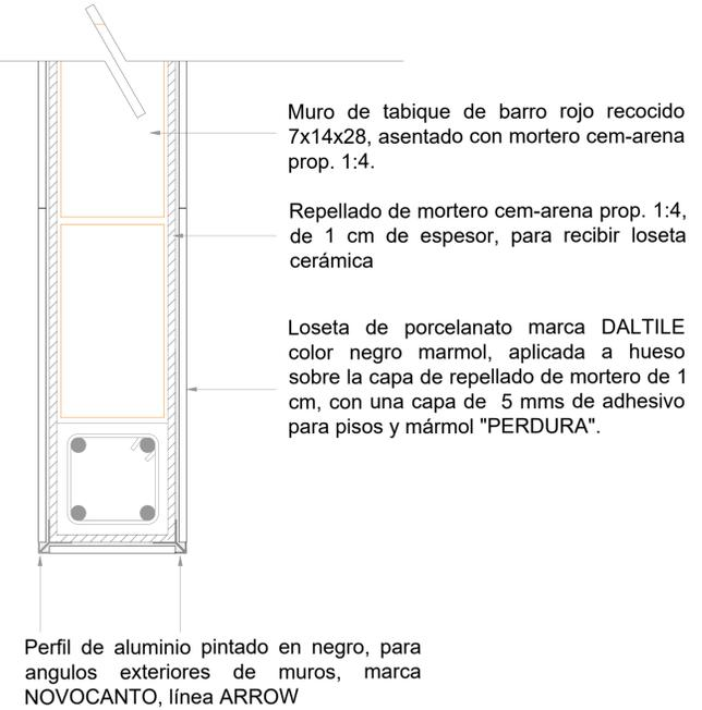
Muro de tabique de barro rojo recocido 7x14x28, asentado con mortero cem-arena prop. 1:4.
