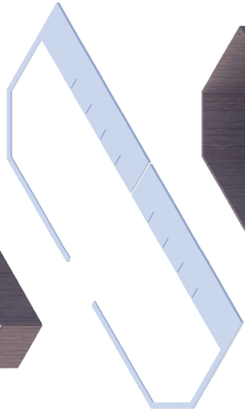
1 BARRA DE COCINA DE MDF LÑAMINADO CON LAMINA FENIX DE ESPESOR DE 0.9mm, COLOR BLANCO ROS
