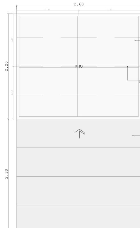
Panel metálico marca MUNDIACERO, modelo INSULADO, de 4" de espesor, lámina calibre 26, relleno con poliestireno y poliuretano. Color blanco interior y exterior.
